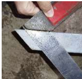
Gambar 8 Hasil Pembagian sudut membentuk sudut 45^\circ
