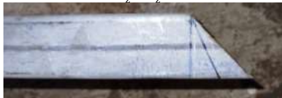
Gambar 10 Pembagian sudut membentuk sudut 22,5^\circ
