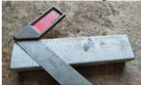
Gambar 7 Proses Pembagian sudut membentuk sudut 45^\circ
